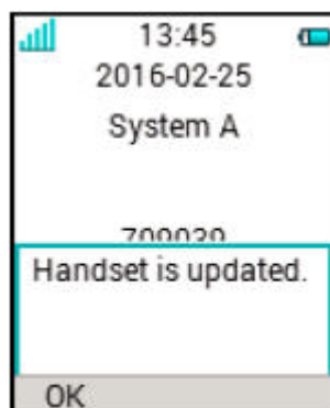
Illustration 9 : Mises à jour installées sur le combiné en charge
