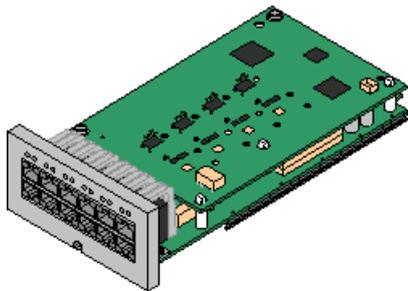
Questa scheda fornisce 6 porte Digital Station (1-6), 2 porte per interni analogici (7-8) e 4 porte trunk analogici (9-12). La scheda è dotata anche di 10 canali di compressione vocale.
