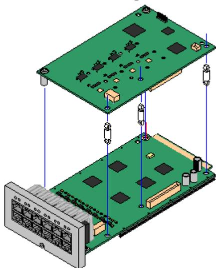
Più [schede di base IP500](#)<sup>24</sup> può essere integrata con schede di linea figlie IP500 per supportare la connessione delle linee alla scheda di base in uso.
