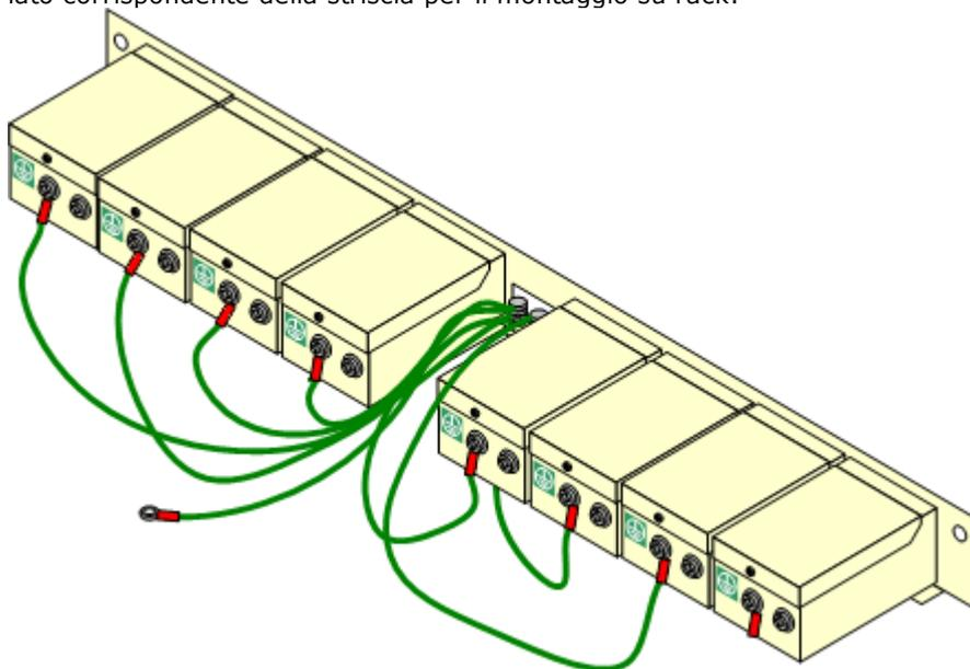
4. Utilizzare il cavo 14AWG con il rivestimento verde e giallo per collegare uno dei perni per la messa a terra alla messa a terra di protezione dell'edificio.
