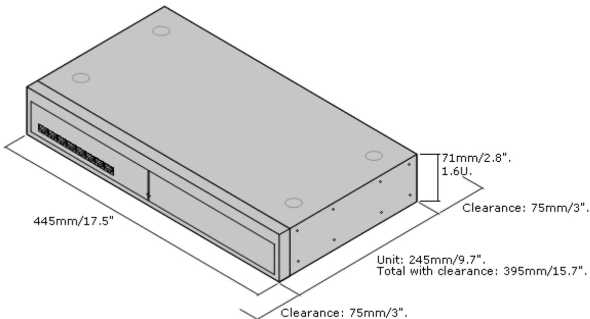
Per i sistemi semipermanenti, è possibile impilare i moduli di espansione esterni sull'unità di controllo. In questi casi e per i sistemi montati in rack, il diagramma seguente mostra le opzioni consigliate per gestire la lunghezza del cavo di interconnessione del modulo.
