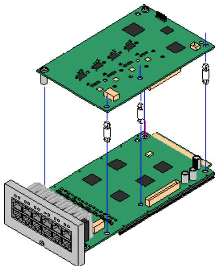
Più [schede di base IP500](#)<sup>224</sup> può essere integrata con schede di linea figlie IP500 per supportare la connessione delle linee alla scheda di base in uso.
