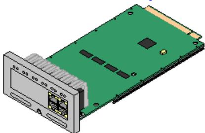
Questa scheda consente di aggiungere 4 ulteriori porte di espansione ai moduli di espansione esterni. Viene fornita con quattro cavi di interconnessione gialli della lunghezza di 2 metri.
