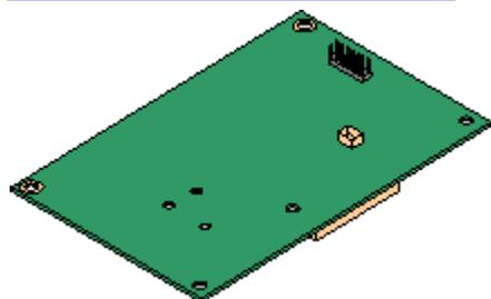
Questa scheda consente alla scheda di base di supportare connessioni di linea PRI. La scheda è disponibile nei modelli a una e due porte. La scheda può essere configurata per il supporto di linee E1 PRI, T1 Robbed-bit, T1 PRI o E1R2 PRI.
