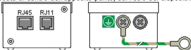
3. La striscia per il montaggio su rack presenta dei perni filettati M4 per la messa a terra. Tramite rondelle e dadi M4, collegare l'altra estremità del cavo di terra del dispositivo di isolamento al perno filettato posto sul lato corrispondente della striscia per il montaggio su rack.
