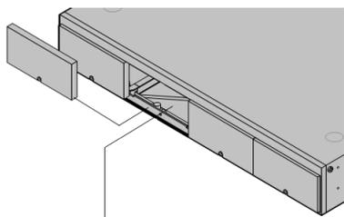
L'unità di controllo IP500 V2 presenta 4 slot per l'inserimento di schede base IP500. Gli slot sono numerati da 1 a 4 (da sinistra verso destra). Possono generalmente essere usati in qualunque ordine. Tuttavia, se si supera la capacità di un particolare tipo di scheda, la scheda nello slot più a destra viene disabilitata.
