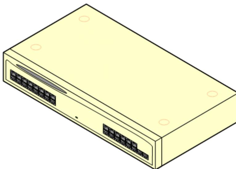
Il modulo Phone V2 sostituisce l'originale modulo IP400 Phone, ora denominato Phone V1. La versione del modulo è indicata da etichette presenti sia sulla base che sul retro del modulo. I principali cambiamenti sono:
