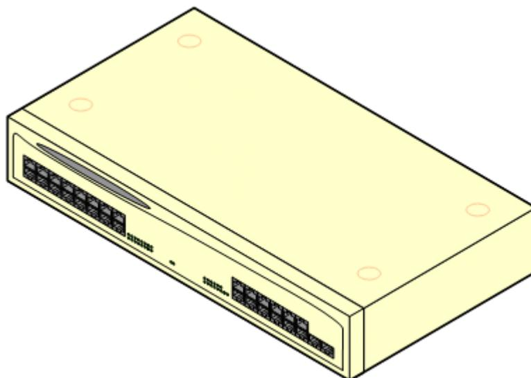
La DS V2 sostituisce l'originale stazione digitale IP400, ora definita DS V1. La versione del modulo è riportata sulle etichette applicate alla base e sul retro del modulo.
