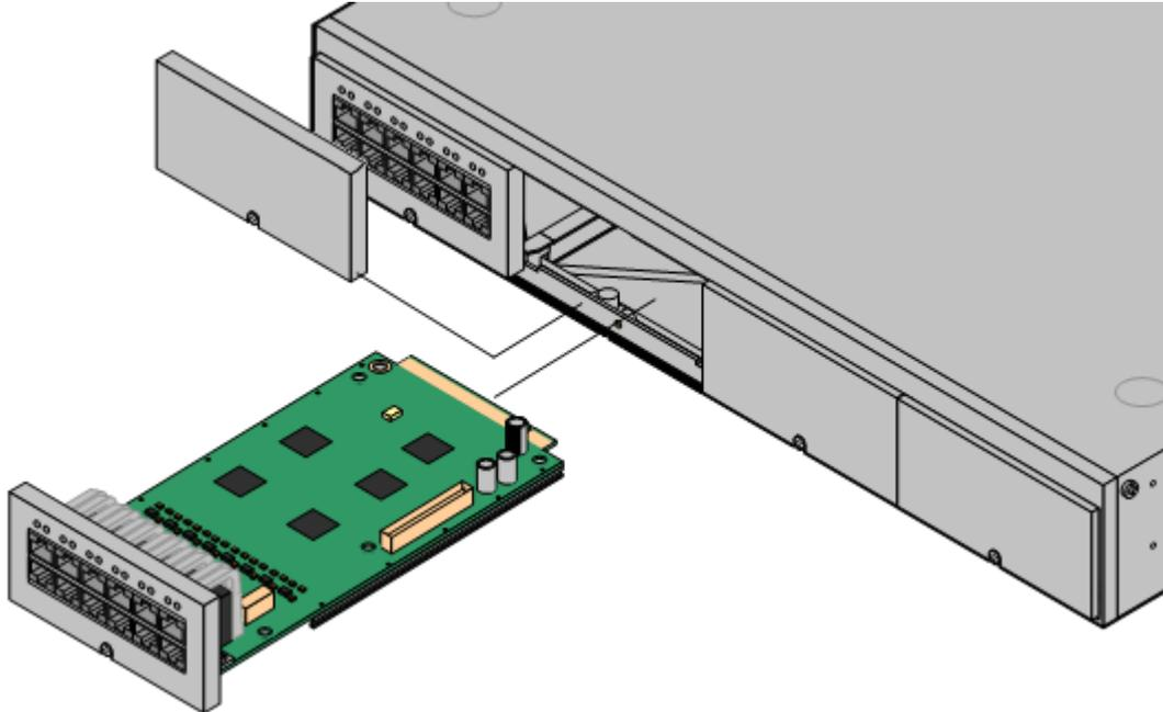
3. Appoggiare la scheda sul fondo dello slot e iniziare a farla scorrere nell'unità di controllo. Dopo averne inserita metà, controllare che i bordi della scheda combacino con i bordi dello slot, provando a ruotarla delicatamente. Se la scheda ruota, rimuoverla e riprovare a inserirla.
