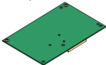
Questa scheda consente alla scheda di base di supportare fino a 4 connessioni di linea BRI, dove ogni linea fornisce canali digitali 2B+D. La scheda è disponibile in modelli a 2 porte (4 canali) e 4 porte (8 canali).
